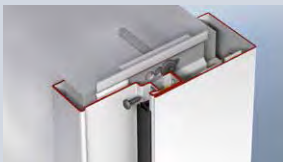
Profil 2 ościeżnicy uzupełniającej należy przykręcić do profilu 1 przez rowek na uszczelkę i zakryć uszczelką drzwiową
